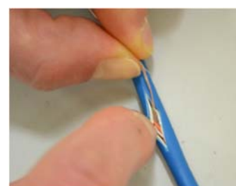
Platzierung eines Thermoelements im Kabel und des Kabels im Bündel
