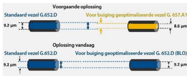
Figuur 1: Zelfs wanneer precies uitgelijnd, gaat er licht verloren wanneer een G.652.D verbonden wordt met een G.657.A1. Dit gebeurt niet langer meer met de nieuwe G.652.D (BLO) vezel.
